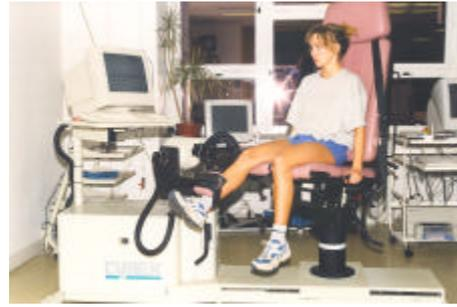
**Abbildung 2** Kniebelastung in der offenen Bewegungskette am rotatorischen isokinetischen System (Cybex-Norm®). Zusätzliche Scherkräfte entstehen durch die Inkongruenz der funktionellen Gelenkachse und der starren Achse des rotatorischen Systems in Kombination mit einer Fixierung des Unterschenkels.
